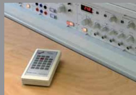
Versenk-Aufbauten werden mit einer zentralen Steuerung im Schrank mit der Raumstromversorgung ausgeliefert. Optional gibt es eine kompakte Funkfernsteuerung, die der Ausbilder mit sich führt.
