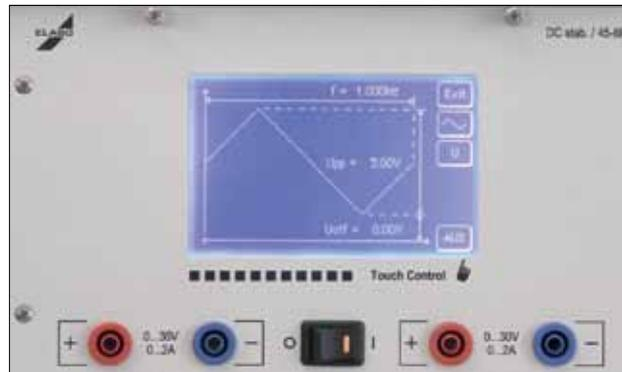
Im frei programmierbaren Modus können bis zu 6 Verläufe mit jeweils 99 Stützpunkten programmiert werden. Hierbei wird immer Anfangs- und Endwert von Strom und Spannung, sowie die Zeitdauer vorgegeben. Bei den Automaten- und Drehgebertversionen ist die Arbiträrfunktion nur mittels Schnittstelle nutzbar.
